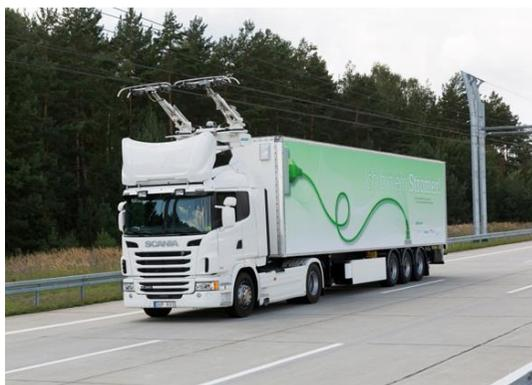
电气化高速公路系统是专为繁忙的货运路线而开发的高能效、低排放解决方案。这个系统由道路高架线缆，以及配备了智能集电器的电动或混合动力的卡车构成。电气化高速路系统的能效约为 80%，大约是柴油卡车的两倍。该系统试点项目已经在德国柏林和美国的洛杉矶港分别展开。
