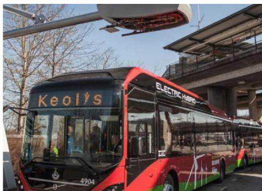
为降低公交车在市区的排放，瑞典斯德哥尔摩市政府沿着一条城市公交线路建设了一套能够为混合动力公交车快速充电的系统。充电站由具备电力转换器和变压器的电网连接系统，以及具备接触臂的充电塔构成。巴士一抵达充电站，就会通过 WLAN 建立无线连接，以识别巴士身份和询问电池管理系统要求。这些巴士能在 70% 线路上仅靠电能行驶——不仅运行安静而且不会产生任何排放。
